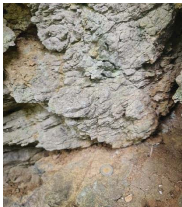
ภาพประกอบที่ 12 แร่โดโลไมต์มีสีเทาสีเทาอ่อนถึงเทาเข้มเนื้อละเอียดถึงเนื้อปานกลาง แข็งแต่ค่อนข้างเปราะ (ถ่ายจากบริเวณพิกัด 479223 E 927126 N L7018)
